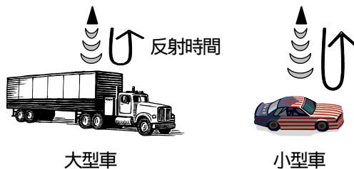
図 - 4 反射時間による車種判定のイメージ
